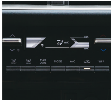
Control de aire acondicionado digital
