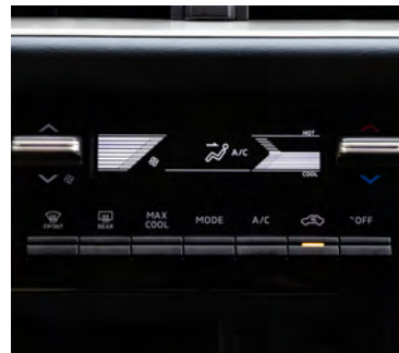
Control de aire acondicionado digital
