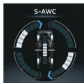
S-AWC es MITSUBISHI MOTORS a tiempo completo, Vehículo integrado basado en 4WD con un sistema de control dinámico que optimiza y potencia de conducción y frenado en cada rueda para más potencia, mejores curvas y mejor estabilidad en cualquier condición de manejo.
