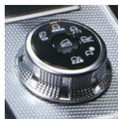
Seleccione entre seis modos de manejo diferentes para disfrutar conducción segura en cualquier condición de la carretera: NORMAL, ECO, ASFALTO, GRAVA, NIEVE, y LODO (solo para 4WD)
